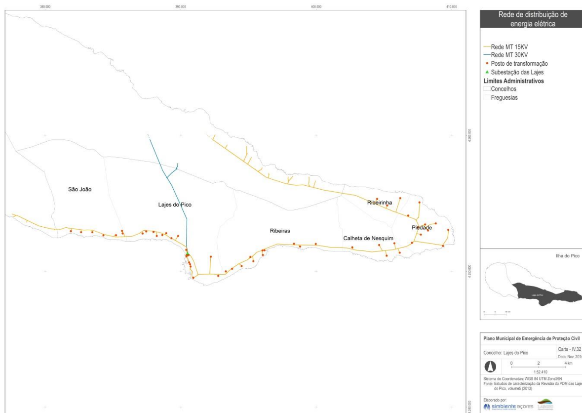
Figura II.4| Rede de distribuição de energia elétrica no município das Lajes do Pico
